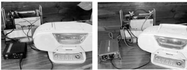
矩形波タイプ 正弦波タイプ 電化製品の接続写真
