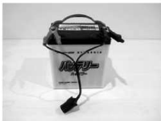
ワニ口クリップ 赤(+ )をバッテリー 端子(+ )へ。 ワニ口クリップ 黒(- )をバッテリー 端子(- )へ接続。
