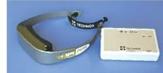
(筋電式入力装置)
