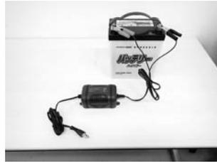
充電器のワニ口クリップ赤(+)をバッテリー(+)端子、ワニ口クリップ黒(-)を車のバッテリー(-)端子へ接続する。
