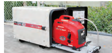
防音ボックスで雨を保護しています
